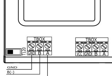
**UWAGA:** Dla ostatniego urządzenia pracującego w sieci BMS wymagane jest ustawienie przełącznika SW2 w prawą pozycję.
