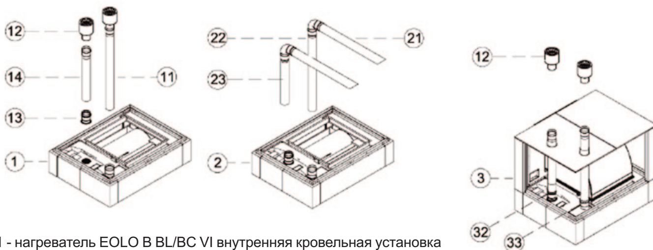
Рис. 6.7. Примеры воздушной и дымовой систем типа С
